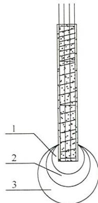
图 4.3.1 抗拔载体桩构造
