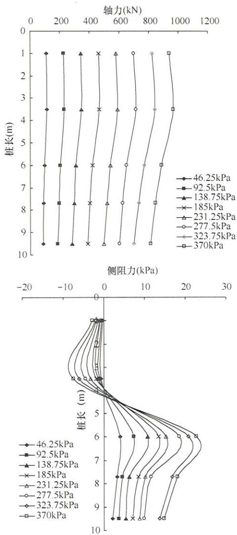
图 3 某载体柱复合地基加载时实测侧
