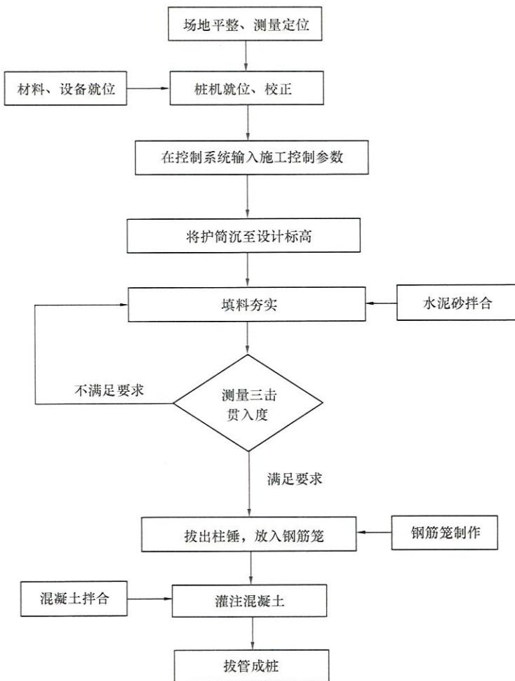
图 6.0.4 载体桩施工工艺
